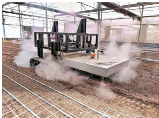
↑自走式土壤蒸氣消毒機可應用於降低土傳性病蟲害、殺滅雜草種子及改善連作障礙
