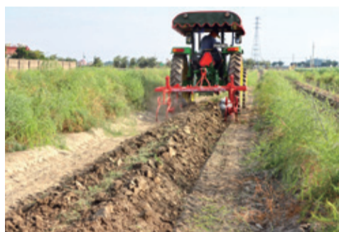
↑由曳引機帶動中耕培土機的犁片將兩側土壤向中間集中，達到培土的效果
