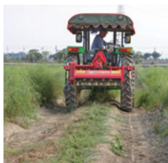
↑蘆筍碎枝機刀軸搭配槌刀運轉時可將母莖碎除
