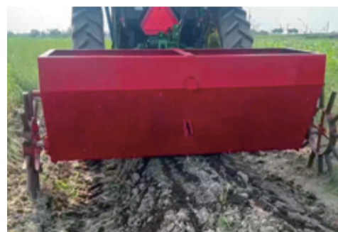
↑曳引機行進時同步帶動太陽輪轉動，將有機質肥料均勻帶狀撒布於畦面
